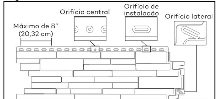
2 - Nunca martele ou fixe completamente os parafusos; deixe uma folga de 1/16" (0,16 cm) entre a canaleta e a cabeça do parafuso (Figura 2). Use sempre parafusos ou pregos não corrosivos com uma cabeça de 0,4" (1 cm) de diâmetro e corpo de 0,150" (0,38 cm) de diâmetro, penetrando-os em uma superfície sólida por, pelo menos, 1 1/4" (3,18 cm) e em um substrato sólido por, pelo menos, 7/16" (1,11 cm).
