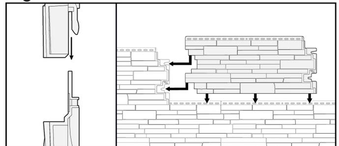
4 - Ao usar um corte de acabamento (canaleta J, cantoneira externa etc.), deixe um espaço de 1/4" (0,64 cm) entre o corte e a TandoStone (Figura 4). A abertura obrigatória para o corte de acabamento é de 1 1/8" (2,86 cm).
