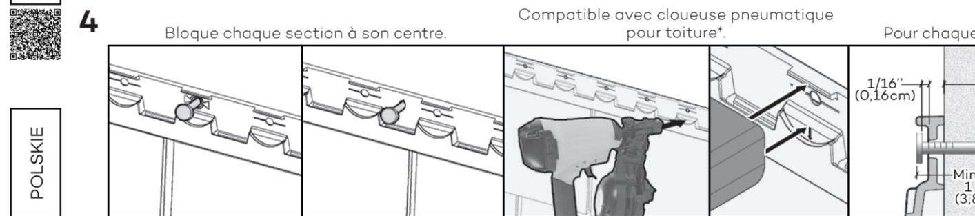
Lors d'utilisation d'une section complète, fixer dans le trou central d'abord. Lors d'utilisation d'un section coupée, fixer en son centre tel qu'illustré. Pour chaque clou, laisser un espace entre la tête du clou et la section. Lors de l'utilisation d'une cloueuse pneumatique, ajuster l'embout à la plus haute position ainsi que la pression d'air selon le substrat afin de laisser l'écart nécessaire.
