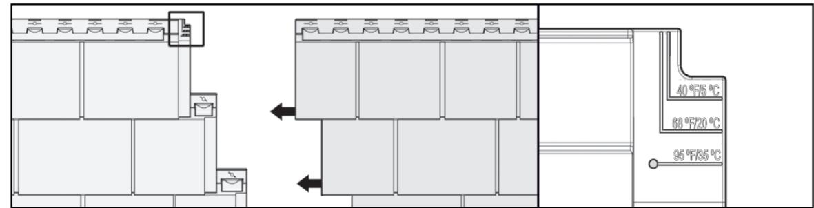
Pour des température inférieure à 40°F(5°C), positionner la section légèrement à droite (1/16"(0,16cm)) de la ligne de température 40°F(5°C).
