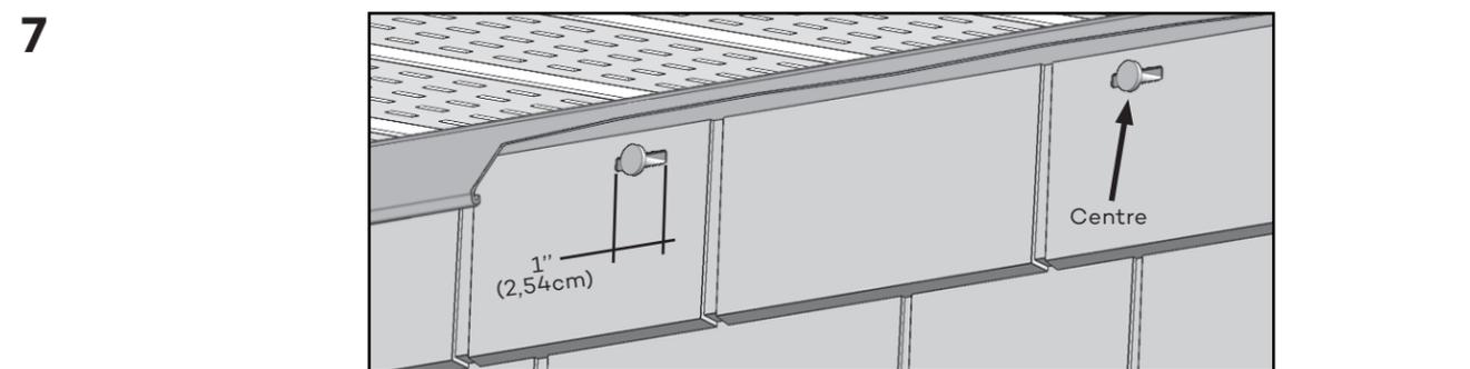
Si vous devez fixer les sections dans un endroit autre que dans les trous de fixation, faire une fente de 1"(2,54 cm) pour permettre de clouer. Toujours clouer au centre de la fente.
