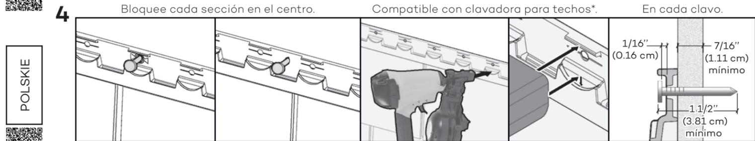
Cuando se instale una sección completa, clave primero el orificio central. Cuando instale una sección cortada, clave el centro como se muestra. En cada clavo, deje un espacio entre la cabeza del clavo y la sección. Cuando use una clavadora para techos, ajuste la punta a su posición más alta y la presión del aire según el sustrato a fin de dejar el espacio requerido.
