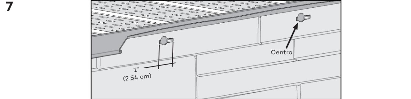
Si necesita sujetar la sección en un área diferente al orificio de instalación, cree una ranura larga de 1" (2.54 cm) para los clavos. Siempre coloque el clavo en medio de la ranura.
