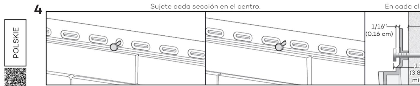
Cuando se instale una sección completa, clave primero el orificio central. Cuando instale una sección cortada, clave el centro como se muestra.
