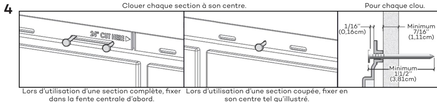
Lors d'utilisation d'une section complète, fixer dans la fente centrale d'abord. Lors d'utilisation d'une section coupée, fixer en son centre tel qu'illustré.
