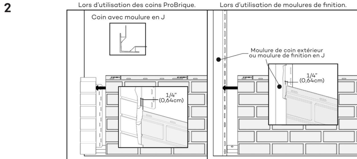
Tous les types de coins doivent être installés avant de débiter l'installation des sections.
